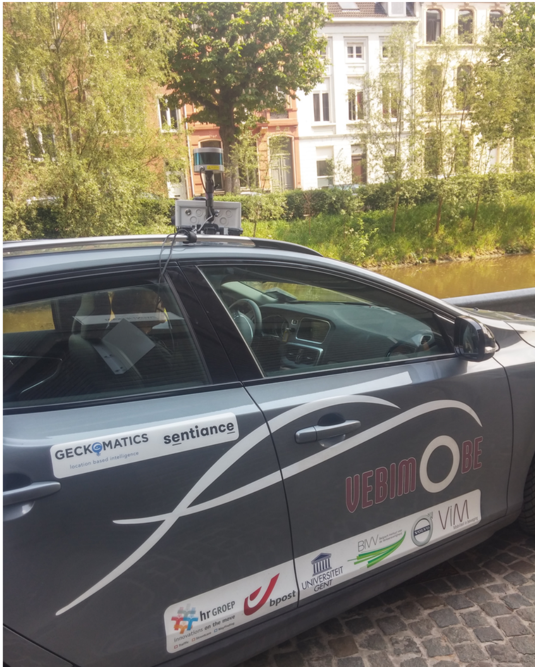
Afbeelding 3: camera's op het testvoertuig
